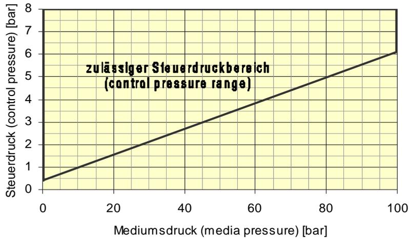
**Steuerdruck-Diagramm AG2 (control pressure diagram)**
